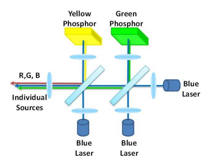
Figure 7. Laser-Phosphor Illumination
