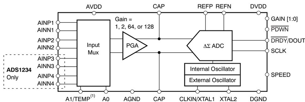
**Figure 3. ADS1232/4 Block Diagram**
